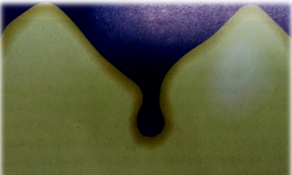
Fisura en forma de "Gota"
